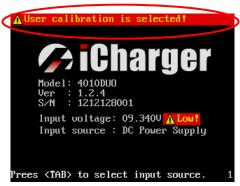
Примечание: "User Calibration" имеет две опции "CH-X Channel Calibration" и "Other Variables Calibration", пользователь может откалибровать один канал в качестве альтернативы. Если пользователь выбрал "User Calibration", соответствующее сообщение появится на экране после загрузки зарядного устройства.
