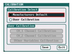
Если пользователь выберет "User Calibration", опции "User Calibration" станут активными; затем выберите канал для входа на экран калибровки.
