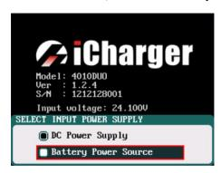
Примечание: Установите тип источника питания в SYSTEM MENU → Charger Setup → Power Supply; подробности на странице 22 - Настройка параметров 4010DUO.
